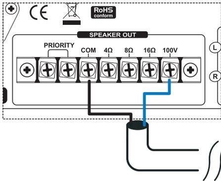
Conecte los dos cables en su amplificador y seleccione la potencia deseada.
