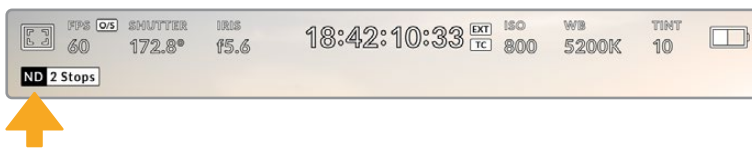
Al ajustar el filtro de densidad neutra en el modelo URSA Mini Pro, aparece el indicador correspondiente en pantalla.
